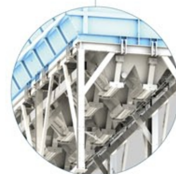
Дозирующие заслонки для заполнителей (2 шибера для каждого отделения бункера)
