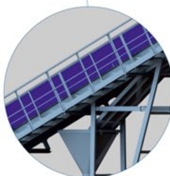
Желоб + бункер разгрузки остатков материала с конвейерной ленты
