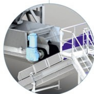
Разгрузка заполнителей с взвешивающего конвейера на наклонный конвейер
